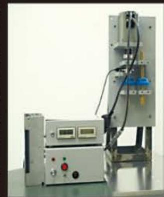
図3 自作した極細金属線用の疲労試験機
