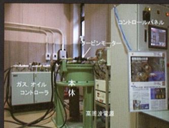
第二世代の高温超重力場発生装置 (100万G, >500°C)
